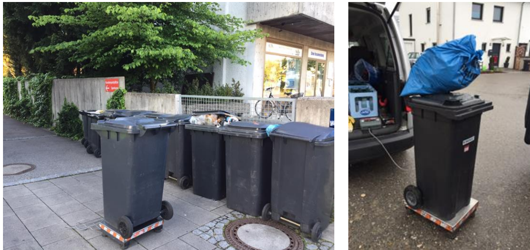
Abb. 4: Behälterverwiegung im Rahmen der Probenahme
