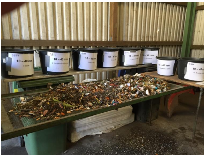
Abb. 5: Nachsortierung der Fraktion 10 - 40 mm
