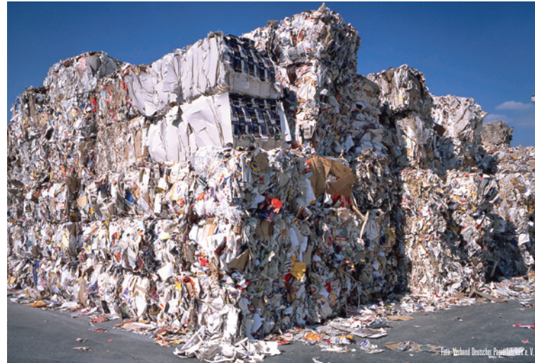
Das gesammelte Altpapier wird zu Ballen verpresst und zur Papierfabrik transportiert.
